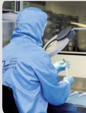
6- Contrôle qualité des implants en salle blanche
